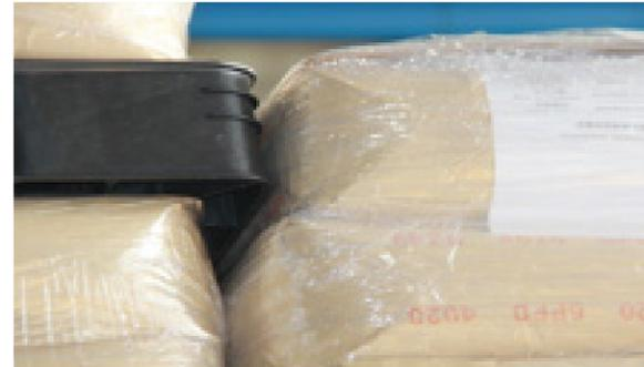
高低平板车装货仅适用枕木，但未使用防护纸板导致托盘和产品包装直接接触易破包
